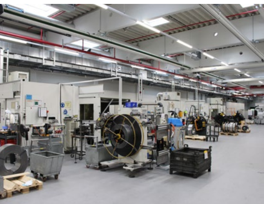
Eine der Produktionshallen von Weidmüller. Sämtliche Maschinen laufen mit Platinol.
