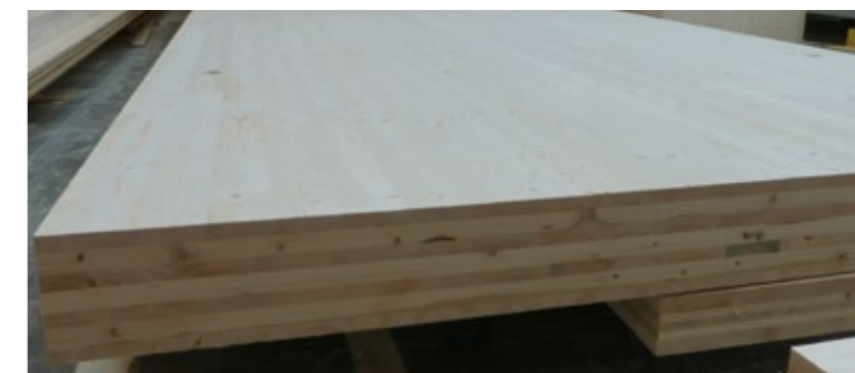
BSP - zukunftsweisender Bauwerkstoff.
