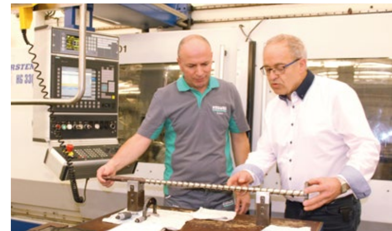
Auch Rotationsteile, wie z.B. Schnecken, werden bei Arburg mit einem vollsynthetischen Kühlschmierstoff aus der Colometa-Familie hergestellt. Siegfried Finkbeiner, Bereichsleiter Produktion (r.), zeichnet verantwortlich für die Produktionsprozesse.
