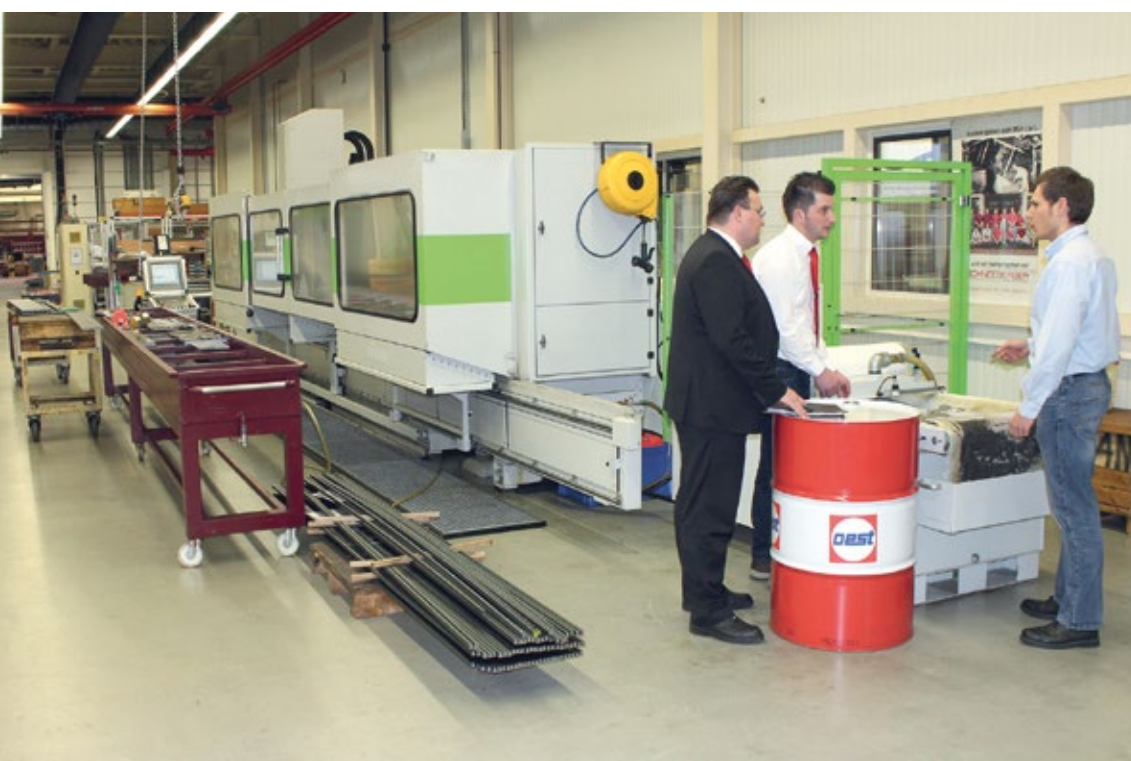
Neben der zentralen Kühlschmierstoffanlage erfordert das KSS-System bei einigen Produktionsprozessen eine separate, dezentrale Kühlschmierstoffversorgung.
