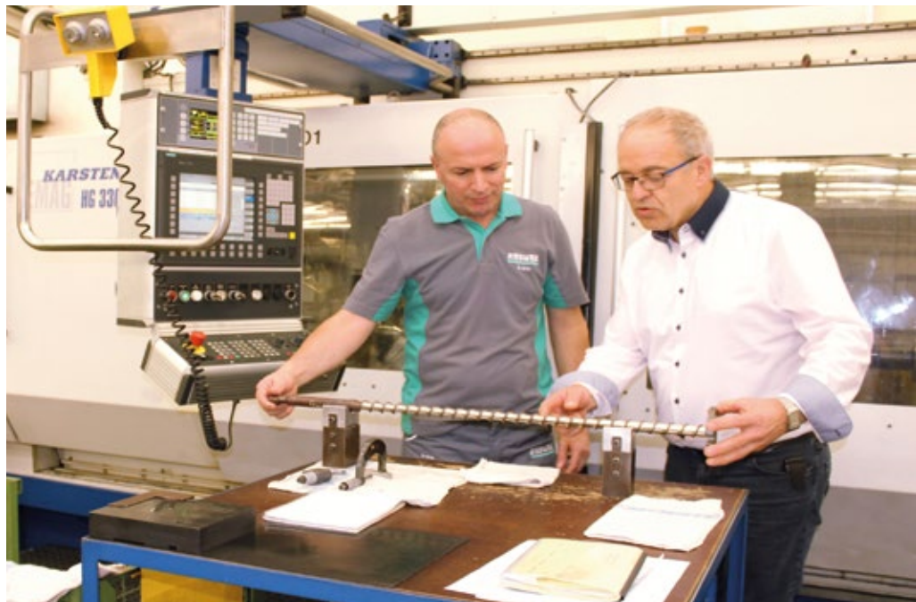
Auch Rotationsteile, wie z.B. Schnecken, werden bei Arburg mit einem vollsynthetischen Kühlschmierstoff aus der Colometa-Familie hergestellt. Siegfried Finkbeiner, Bereichsleiter Produktion (r.), zeichnet verantwortlich für die Produktionsprozesse.
