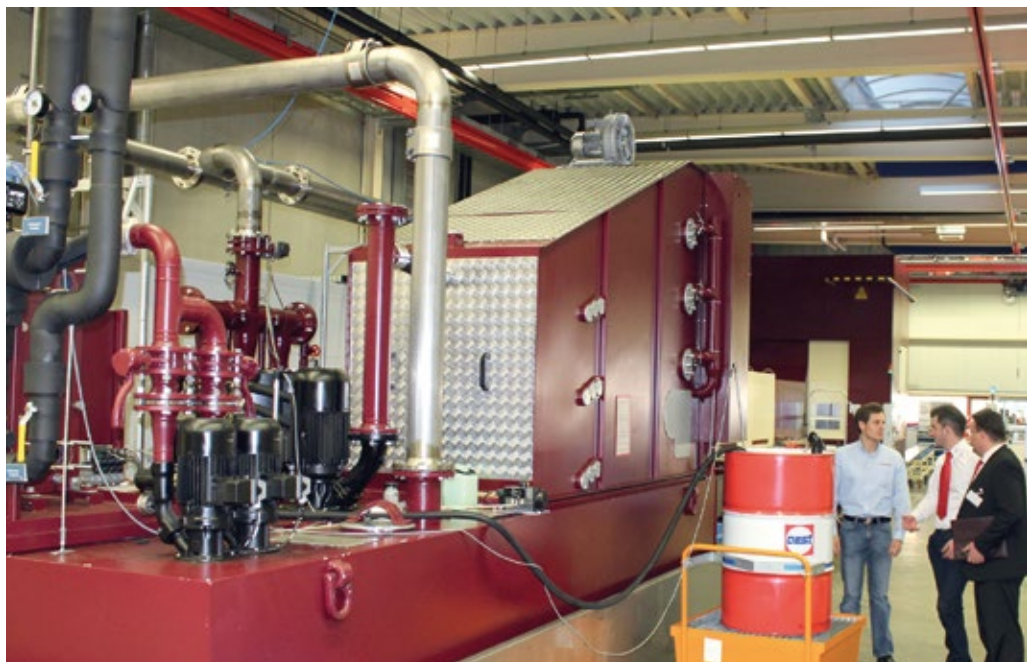
Der Kühlschmierstoff in der Zentralanlage wird regelmäßig überwacht, analysiert und bei Bedarf mit Additiven nachdosiert.
