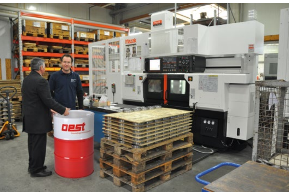
Jede der mehr als 40 Maschinen bei Hennig wird einzeln mit Kühlschmierstoff versorgt, um die Konzentration prozess- und materialabhängig steuern zu können.
