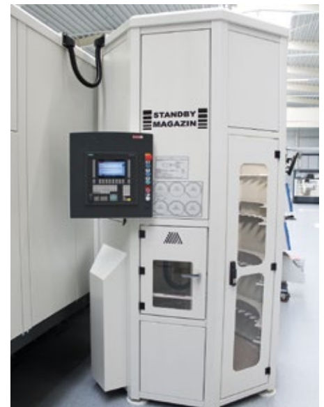
Standby-Magazin für bis zu 200 Werkzeuge.
