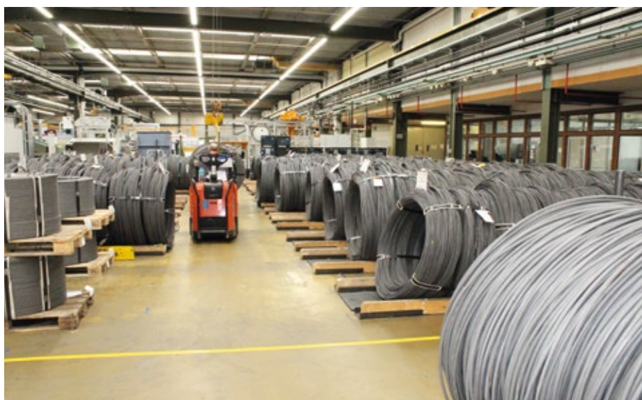
Walzdrähte aus Stählen und Edelstählen – das Rohmaterial für ein breites Produktspektrum von fischer Befestigungselementen.
